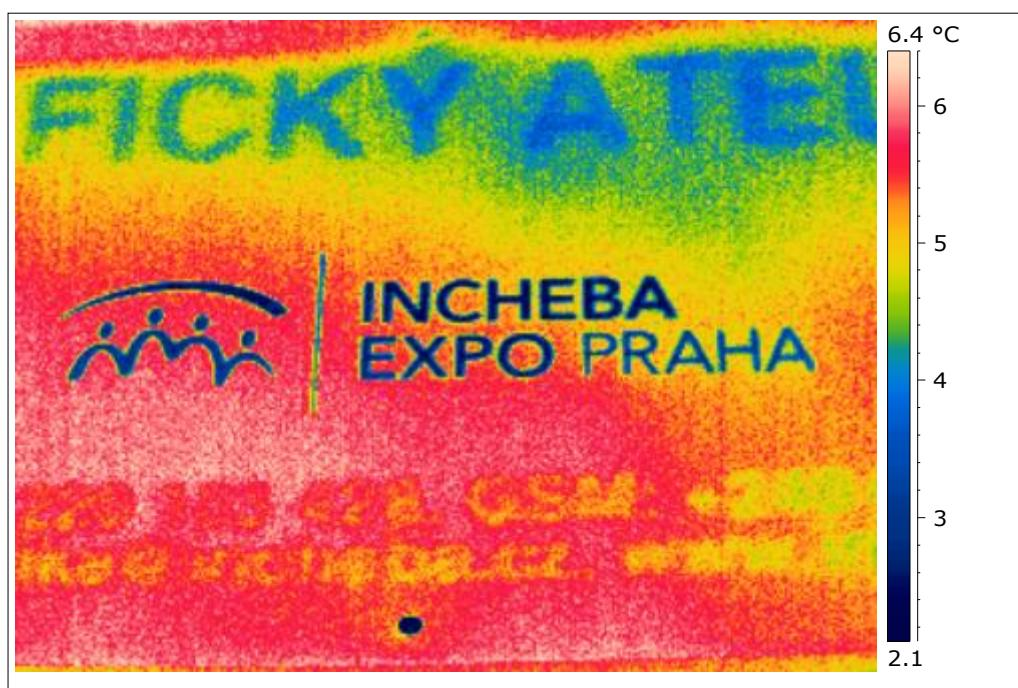
Následující 2 termogramy jsou totožné, pouze je u jednoho nastavena emisivita materiálu 0,9 a u druhého 0,09. Z přiložených tabulek je patrný rozdíl ve zdánlivé povrchové teplotě.
